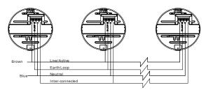
Fig. 7 - Interconnect wiring
